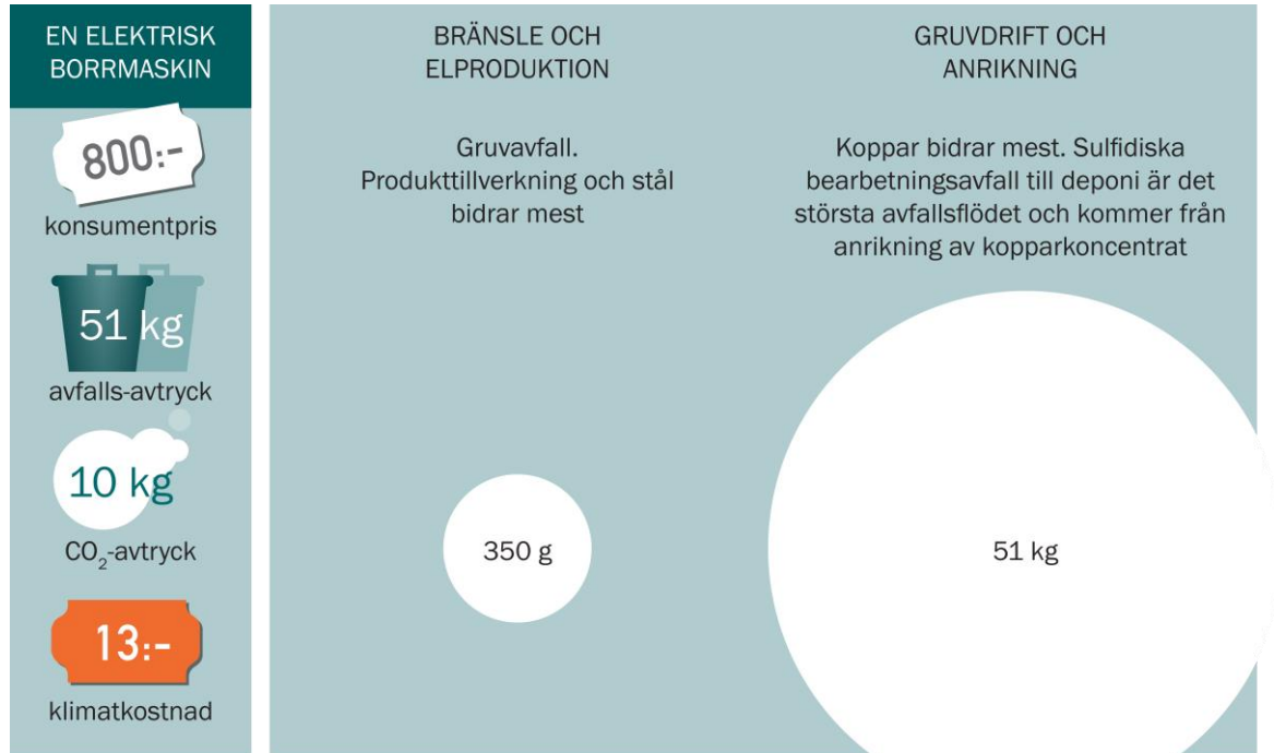
Figur 5 Mängder av avfall som genereras vid produktion av en elektrisk bormaskin, vikt 2,3 kg. Konsumentpriset är en uppskattning. Klimatkostnaden beräknades för växthusgasutsläpp (koldioxidfotavtryck) för total mängd avfall som uppkommer i produktionskedjan. (Illustration: Peter Forsnor)
