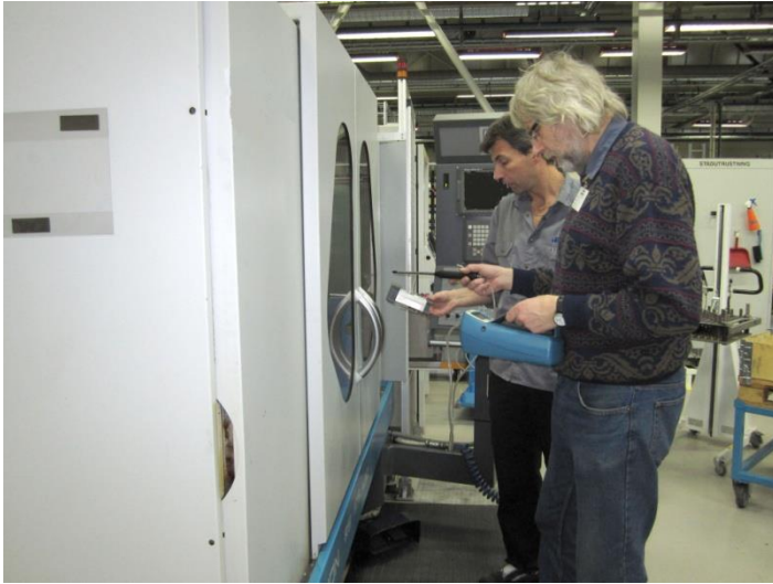
Bild 10. Mätning av halten utanför inkapslingen på en slipmaskin
