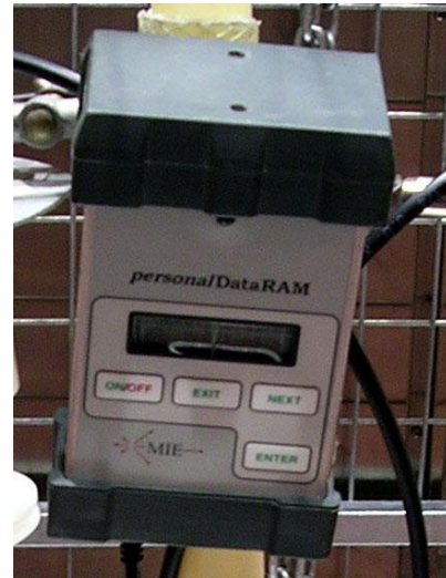
Bild 2. Direktvisande instrument för totalhalt partiklar. Fabrikat MIE och modell pDR 1000 AN.
