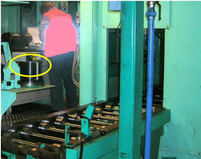
Bild 9. Öppning för bearbetade detaljer. Inringat på bilden ses GRIMM, det partikelmätande instrumentet.
