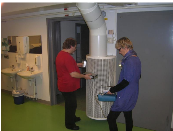
Bild 1. Kontroll av partiklar i tilluften från ett deplacerande don. Mätning med samtliga tre partikelinstrument som användes i projektet.
