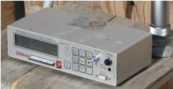
Bild 1. Direktvisande instrument för mätning av respirabelt, bronkialt och inhalerbara partiklar. Fabrikat Grimm och modell 1.108.
