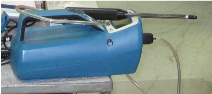
Bild 3. Direktvisande instrument för mätning av nanopartiklar. Fabrikat TSI och modell 8525 P-Trak.
